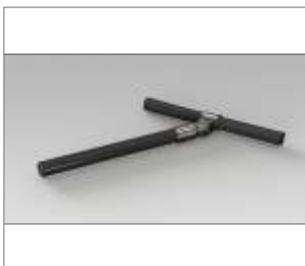
La combinación de E-7A y E-7B crea un elemento de unión de ángulo variable, lo que permite que un tubo se una a la mitad de otro y variar el ángulo. Esto aporta flexibilidad a la estructura. El arrojamiento diagonal es un ámbito en el que se usa con frecuencia. Además, se suelen utilizar dos piezas E-7A para fijar paneles.
